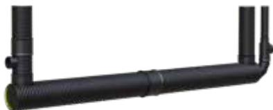
**Anwendung:** SediPipe 800 plus ist eine Regenwasserbehandlungsanlage für belastete Regenabflüsse, z.B. von Verkehrsflächen. Die Anlage scheidet mitgeschwemmte Feststoffe und Leichtflüssigkeiten (Öl) aus dem Regenwasser ab und hält diese Stoffe, auch bei Havarien im Trockenwetter - sowie im Regenfall, zuverlässig zurück.
