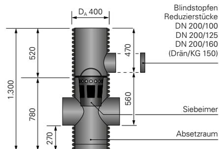
mit schwenkbarem Zulauf
