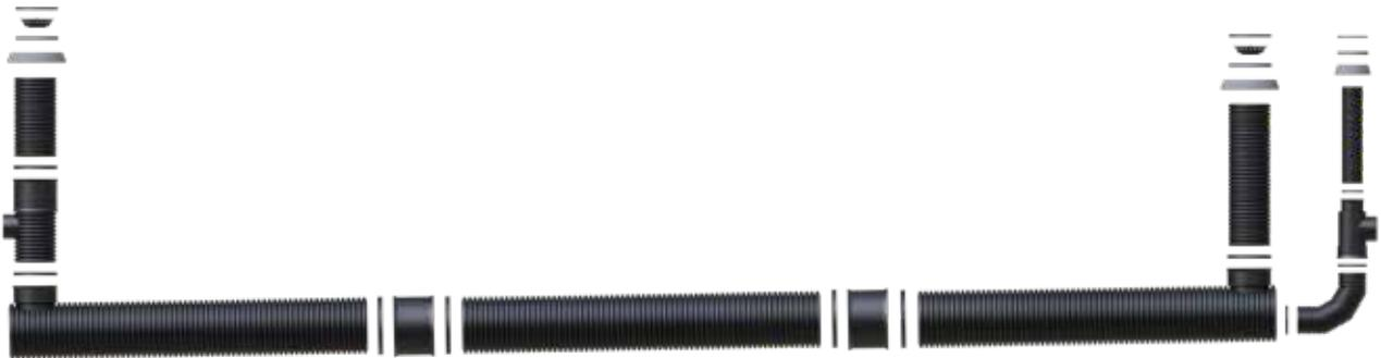
Modularer Aufbau einer SediPipe am Beispiel SediPipe 800/18
