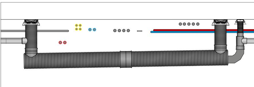
SediPipe-Anlagen können sogar unter bestehenden Medien in einen bestehenden Kanal integriert werden. Dadurch werden zusätzliche Baumaßnahmen hinfällig.
