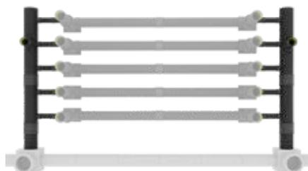
**Anwendung:** Zur Parallelschaltung von mehreren Regenwasserbehandlungsanlagen vom Typ SediPipe / SediSubstrator
