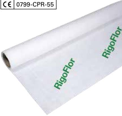
Mechanisch verfestigtes und thermisch behandeltes Rigolenvlies aus PP. Mit außergewöhnlichen Produkteigenschaften, wie hoher Wasserdurchlässigkeit, großer Dicke und optimaler Öffnungsweite; bewirkt eine langfristige Aufrechterhaltung der Filterfunktion. Geotextilrobustheitsklasse 3. CE-zertifiziert nach DIN EN 13252.
