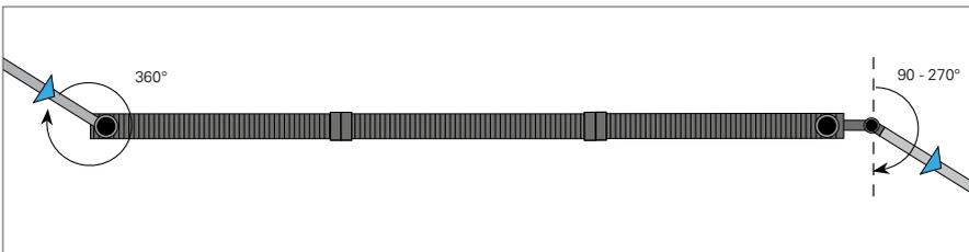
Alle Behandlungsanlagen verfügen über variierbare Zu- und Abläufe. Zu- und Ablauf können somit perfekt an die örtlichen Gegebenheiten angepasst werden.
