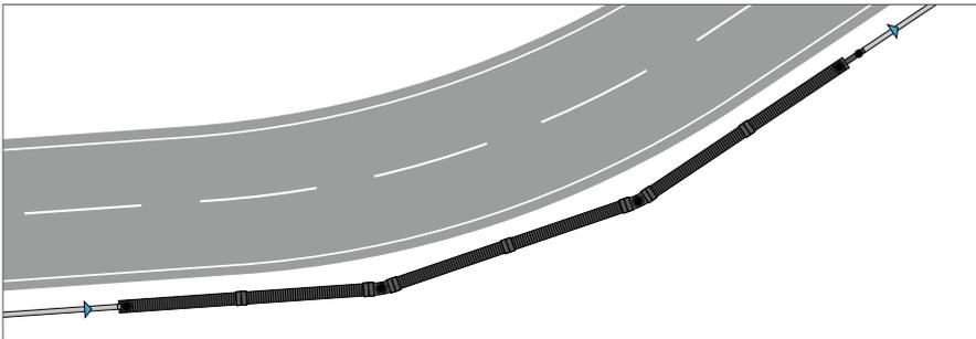
SediPipe 800 mit Abwinklung kann entlang einer Straße direkt in den / oder einen bestehenden Kanal eingebunden werden. Die Behandlung erfolgt somit direkt im Kanal, was eine aufwendige und kostspielige Einbindung externer Behandlungsbauwerke überflüssig macht.
