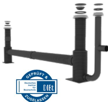
**Anwendung:** SediSubstrator L ist eine Regenwasserbehandlungsanlage für stark belastete Regenabflüsse, z. B. von Verkehrsflächen. Die Anlage scheidet mitgeschwemmte Feststoffe, partikulär gebundene Schadstoffe, gelöste Schwermetalle und Leichtflüssigkeiten (Öl) aus dem Regenwasser ab und hält diese Stoffe zuverlässig in der Anlage zurück.
