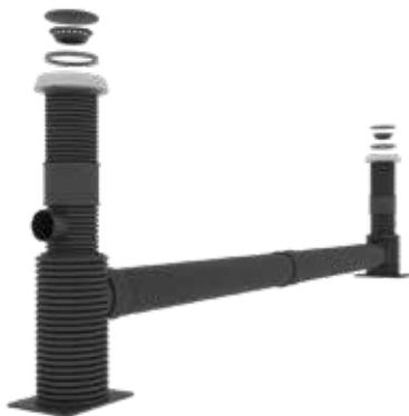
**Anwendung:** SediPipe L plus ist eine Regenwasserbehandlungsanlage für belastete Regenabflüsse, z.B. von Verkehrsflächen. Die Anlage scheidet mitgeschwemmte Feststoffe und Leichtflüssigkeiten (Öl) aus dem Regenwasser ab und hält diese Stoffe, auch bei Havarien im Trockenwetter - sowie im Regenfall, zuverlässig zurück.
