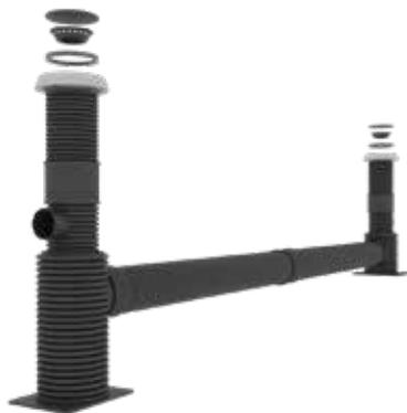
**Anwendung:** SediPipe L ist eine Regenwasserbehandlungsanlage für belastete Regenabflüsse, z.B. von Verkehrsflächen. Die Anlage scheidet mitgeschwemmte Feststoffe und Leichtflüssigkeiten (Öl) aus dem Regenwasser ab und hält diese Stoffe, auch bei Havarien im Trockenwetterfall, zuverlässig zurück.
